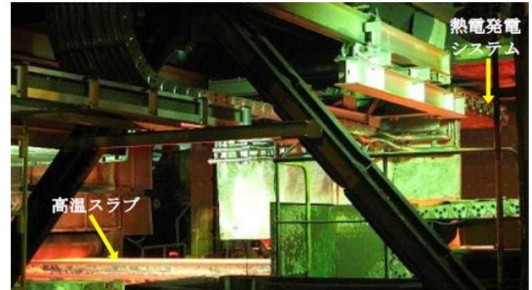
連続鋳造設備へ設置した熱電発電システムの外観
